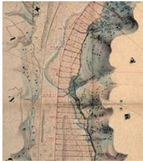
Schéma : L'eau du var est acheminée derrière la digue par un canal d'amenée dans les casiers où on laisse décanter les limons avant de restituer l'eau au fleuve
